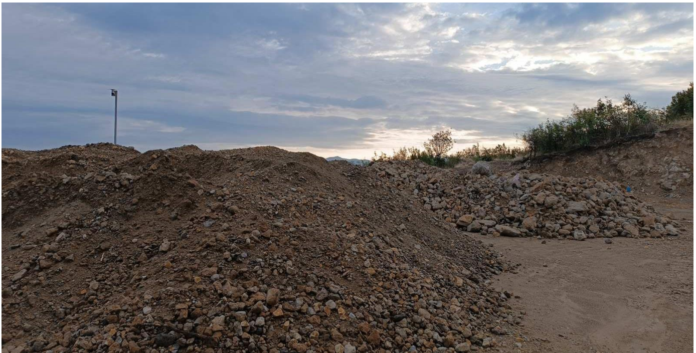
ΦΩΤΟ 4: Άποψη του σωρού ποζολάνης που προκύπτει από την κοσκίνιση του εξορυχθέντος αργού υλικού και είναι έτοιμο προς φόρτωση και μεταφορά στο εργοστάσιο της Θεσσαλονίκης. Στο βάθος δεξιά διακρίνεται ο σωρός των στείων υλικών της κοσκίνισης προς απόθεση, ενώ στο βάθος αριστερά διακρίνεται η κάμερα 24ωρης παρατήρησης, για λόγους ασφάλειας.
