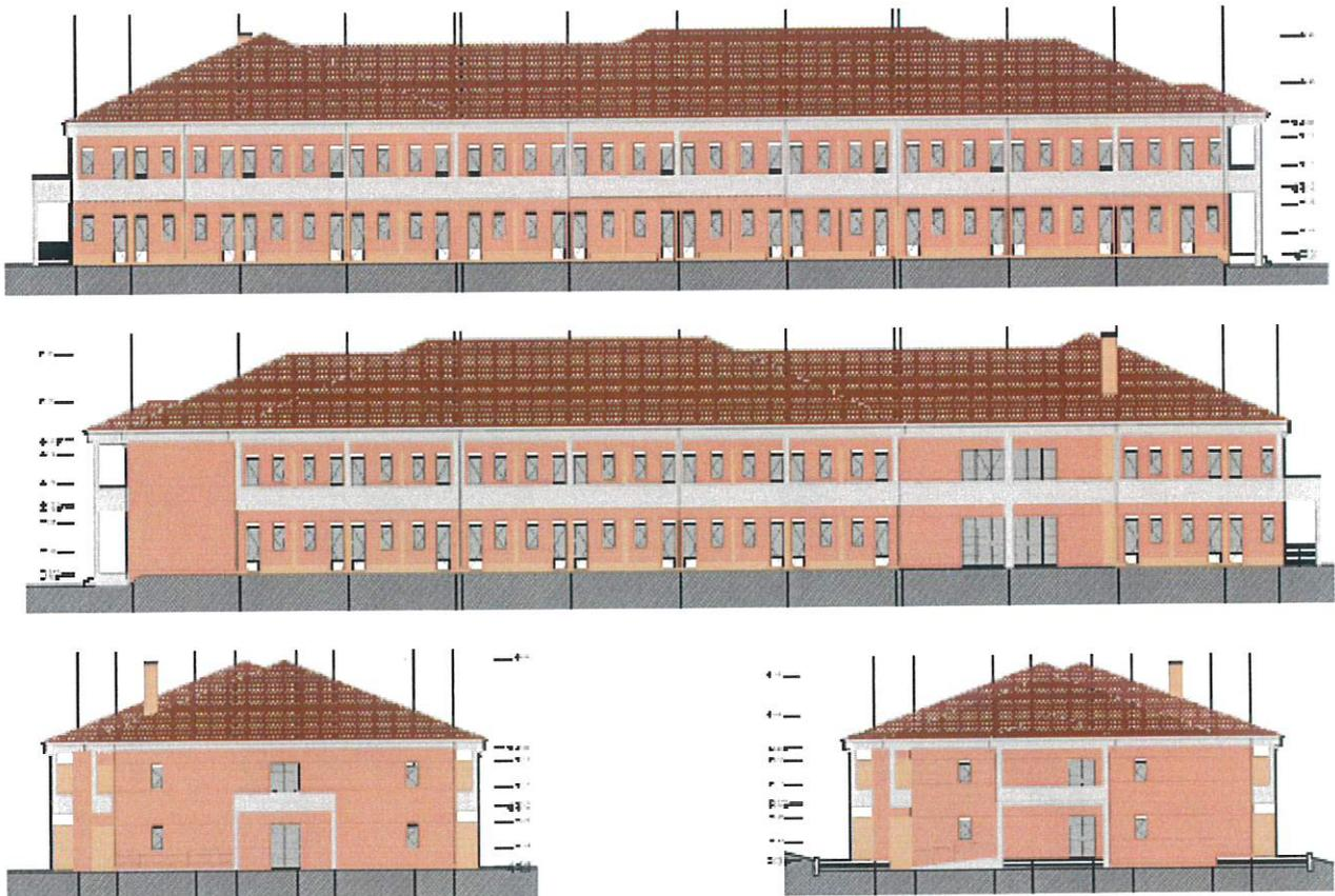
Το κτίριο καλύπτεται σε όλη την επιφάνειά του με στέγη και επικάλυψη από ρωμαϊκά κεραμίδια που τοποθετούνται κολυμβητά επί επιφανειών κόντρα πλακέ θαλάσσης, οι οποίες προ της τοποθέτησης των κεραμιδιών, θα έχουν καλυφθεί με ασφαλτόπανο, του οποίου η άνω επιφάνεια είναι
